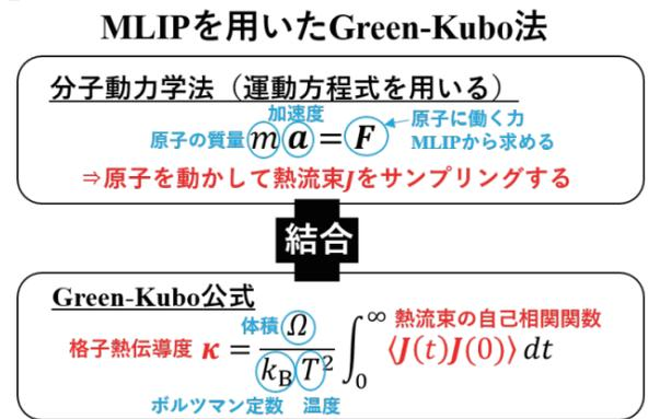
機械学習原子間ポテンシャル (MLIP) を用いた Green-Kubo 法。原子の運動パターンは分子動力学法に基づくシミュレーションにより、計算機の中で原子を運動させることで得られる。運動方程式を解く際に MLIP から得た原子に働く力が使われる。運動パターンが反映された熱流束から、Green-Kubo 公式を通して格子熱伝導度が計算される。
