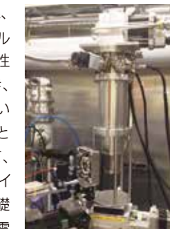
大型放射光施設 SPring-8（兵庫県西播磨）のビームラインに設置された熊本大学所有の超低温蛍光 X 線ホログラフィー装置
