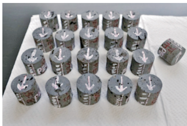
図2:火山の溶岩(玄武岩)サンプル。このようなサンプルの残留磁化を実験室で測定し、過去の地球磁場の情報を復元する。サンプルサイズは25mm。
