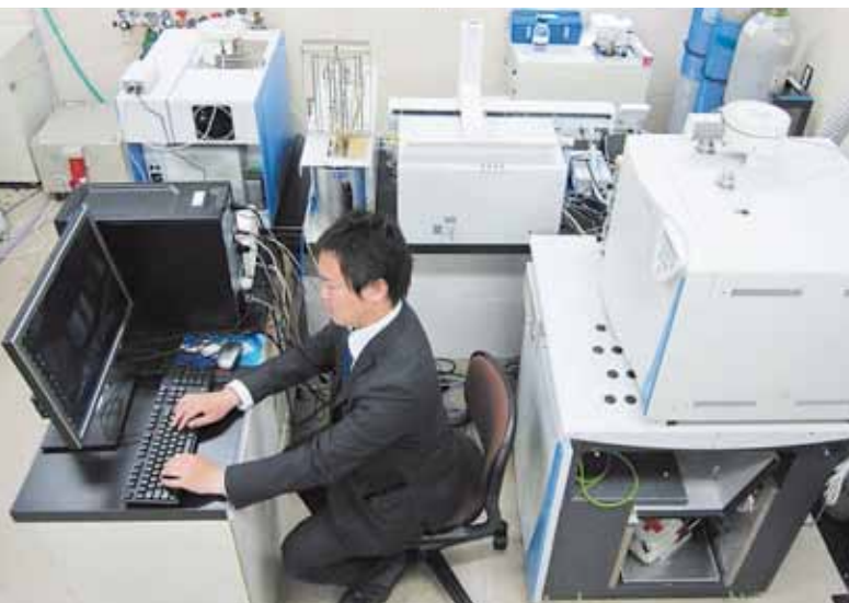
上／江津湖脇の自噴井戸（熊本の地下水システムの理解） 右／菊池台地の不飽和土壌層のコア採取作業（地上からの窒素負荷の実態把握調査） 左／地下水質の挙動を把握するためのマルチ同位体（O,H,C,S,N）測定システム
