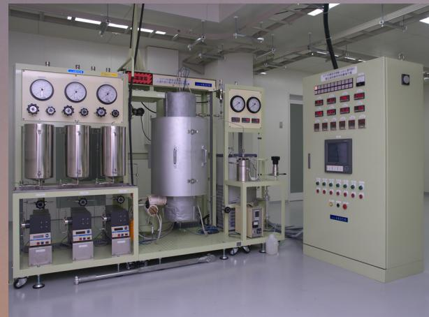
↑ 高温・高圧热水の流れによる、岩石・鉱物の変化と物質の移動過程を再現するための実験装置。
