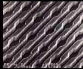
CVDダイヤモンド膜を窓材としたX線露 光用マスク(左)とCVDダイヤモンド膜上 に形成された金属パターン
