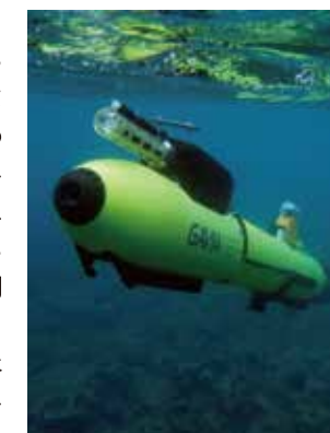
各種センサーを装備したAUV (自立型無人探査機) による調査風景
