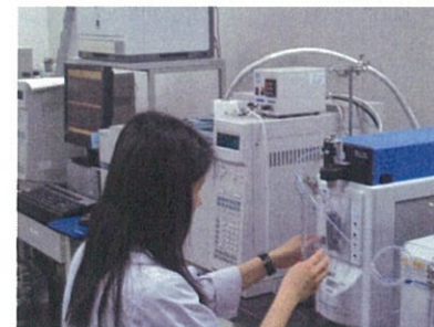
■ パージ・トラップ・ガスクロマトグラフ質量分析装置 (PT-GC-MS) による分析
