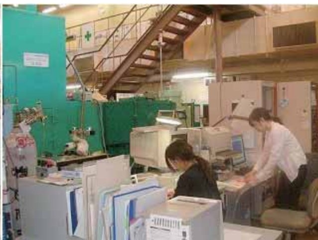
中性子ガイドビームの末端にある即発γ線分析装置
